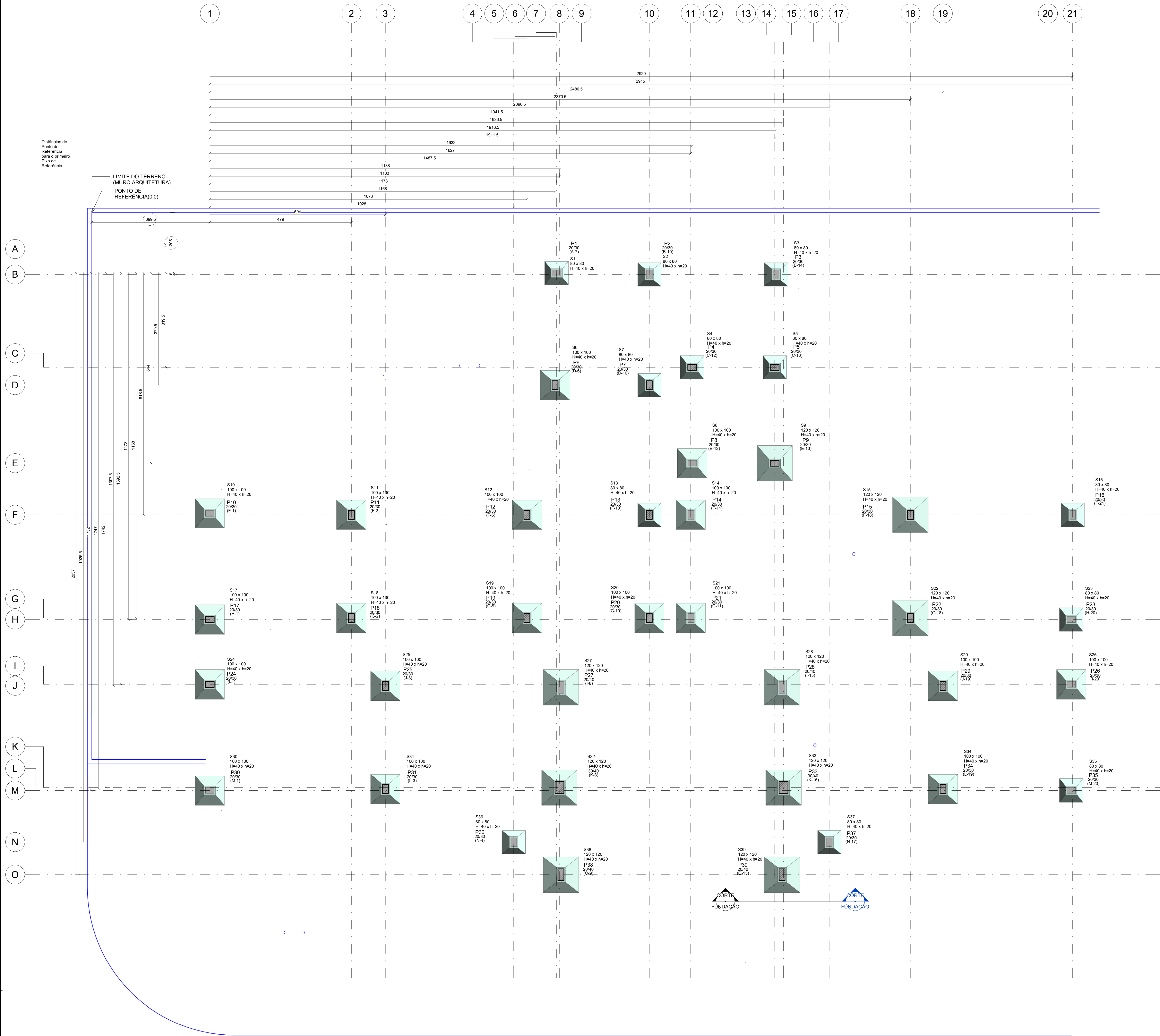
PLANTA DE LOCAÇÃO DE FUNDAÇÃO 1 : 50
